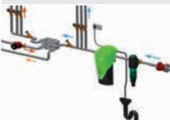
Das BIOCAT KS 3000 wird direkt am Hauptwasserzugang nach dem Wasserzähler, Druckminderer und dem Hauswasserfilter installiert.
