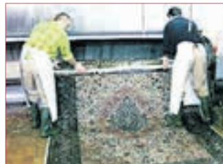
DAS AUFROLLEN auf eine Wellenschleuder; die Wasser herausschleudert.
