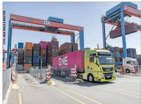
SIEHTE WIE EIN GANZ NORMALER LKW AUS, fährt aber vollautomatisch. Aktuell werden autonome Lkw beispielsweise an Containerterminals getestet. Der Fahrer ist weiter an Bord - und kann während des Verladens seine Lenkpause machen. (tbn)
