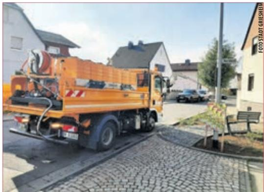
DER GIESSARM hat eine seitliche Auslage von bis zu 7 Metern.
