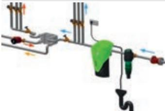
Das BIOCAT KS 3000 wird direkt am Hauptwasser- ein- gang nach dem Wasserzähler, Druckminderer und dem Hauswasserfilter installiert.
