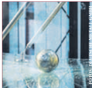
links: Vordächer müssen so konzipiert und befestigt sein, dass sie auch schwere Schneelasten tragen. rechts: Echtglas-Vordächer im Test.
