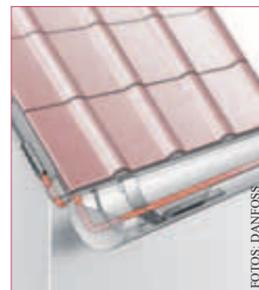
DAS BEGLEITHEIZBAND SLIG hält Dachrinnen im Winter zuverlässig eis- und schneefrei. Aufgrund der selbstlimitierenden Funktionsweise passt es seine Leistung der Umgebungstemperatur an. Elektronische Thermostate und Witterungsfühler sorgen für eine effektive Regelung.
