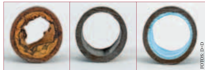
Rohr verkrustet (li), rohr gereinigt (mi), Rohr beschichtet (re)
