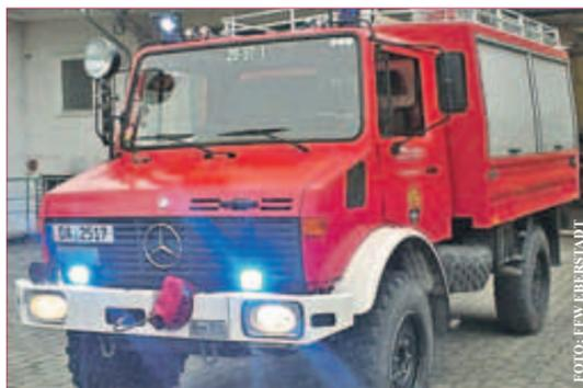
**BESSER GEHÖRT UND GESEHEN.** Um die Sicht- und Hörbarkeit des RW1 (Rüstwagen) der Freiwilligen Feuerwehr Eberstadt auf Einsatzfahrten zu erhöhen, wurde das Fahrzeug mit einer Pressluft-Martinshorn-Anlage und Frontblitzern ausgestattet. Der RW1 ist ein Feuerwehrlfahrzeug, das bei der technischen Hilfeleistung eingesetzt wird. Dazu steht umfangreiches Werkzeug und Spezialgerät zur Verfügung, mit dem Personen beispielsweise nach einem Verkehrsunfall aus Ihren Fahrzeugen befreit werden können.
