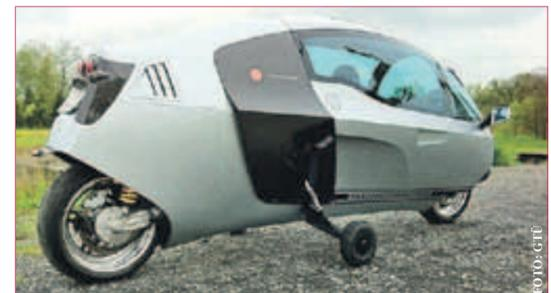
**REVOLUTIONÄR!** Der MonoTracer® der Schweizer Firma PE-RAVES AG, der mit über 240 km/h Spitze u. einem Verbrauch von unter 1,0 Liter/100 km (äquivalent) der schnellste, effizienteste, batteriebetriebene Elektro-Hochleistungs-Zweiräder der Welt ist. (GTÜ)
